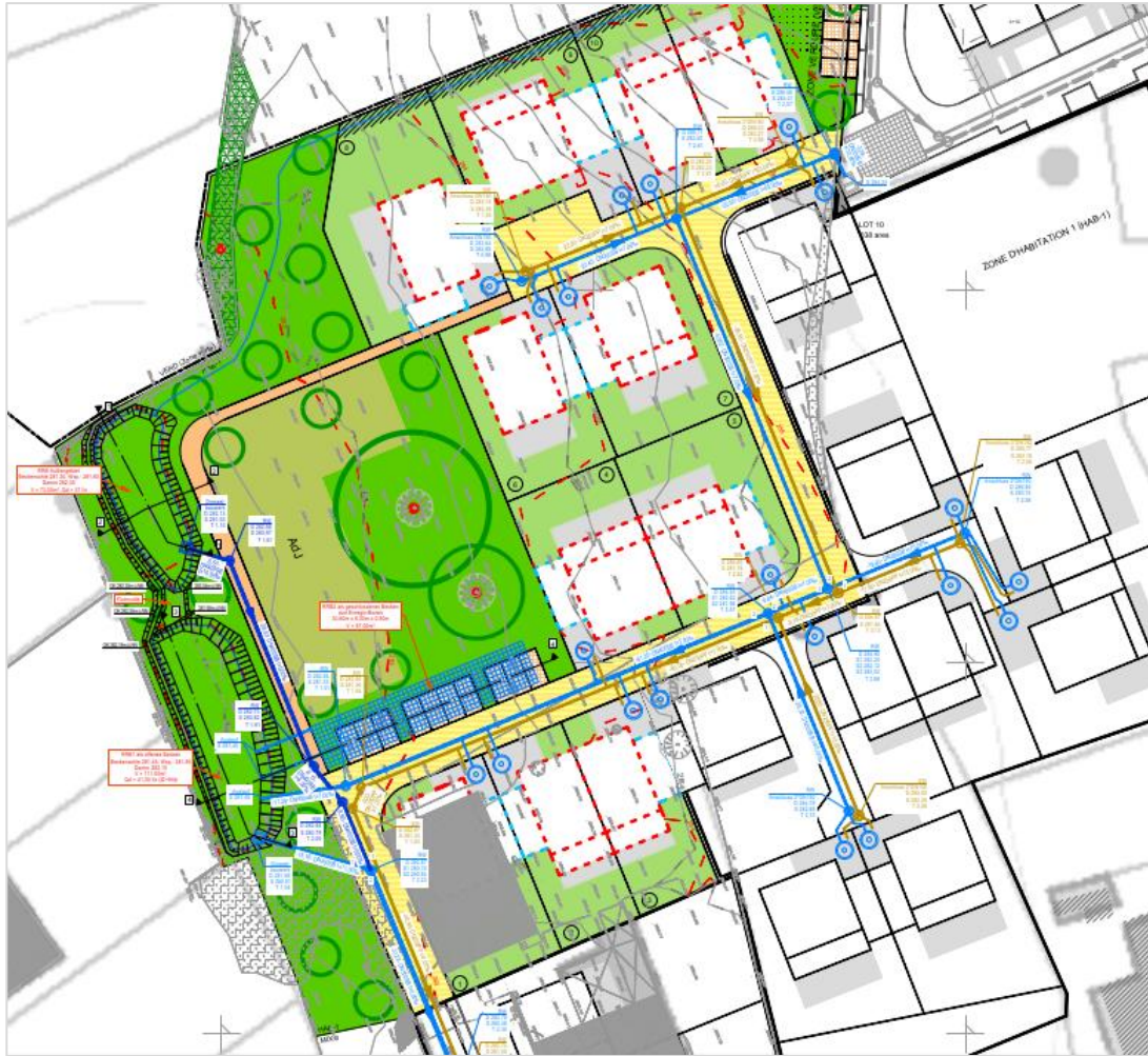
Figure 15 : Extrait du plan du concept d'évacuation des eaux du PAP (réf. 181022-2-250b)
