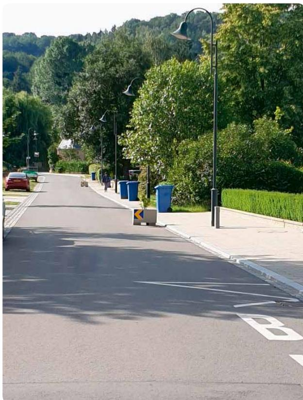
Pour l'entrée des zones résidentielles la commission conseille de fixer les panneaux à une hauteur d'environ 1m. Vu l'absence de trottoirs dans ces zones la pose des panneaux comme montrée sur la photo dans la colonne de droite est acceptable et ne pose pas de problèmes.
